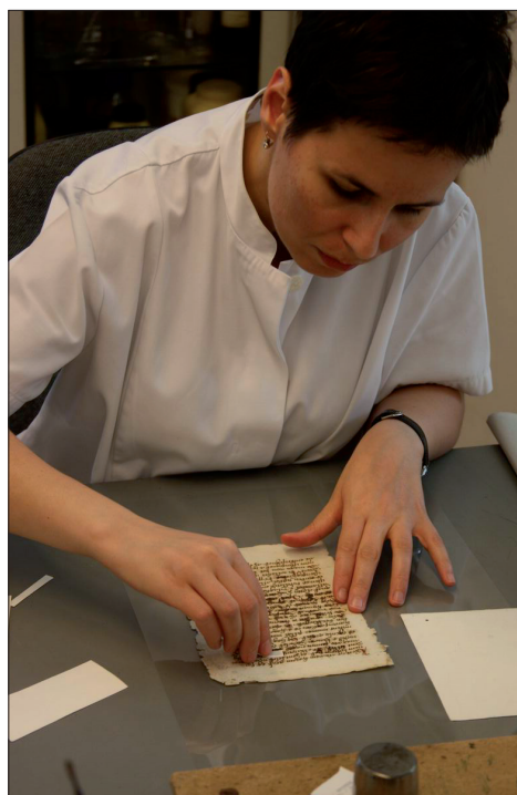
61. ábra Vasteszt végezése a kódex egyik lapján
