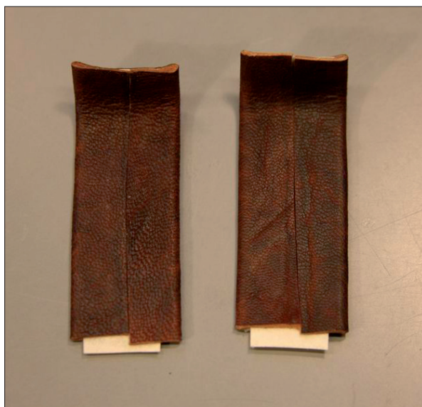
100. ábra Az új, hajtott és a hátoldalán élben illesztett szíj
