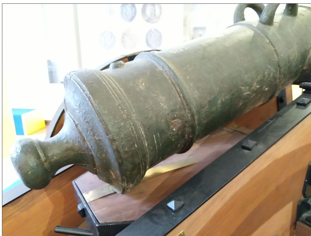
2. ábra A magtámasz helye a csőfaron
