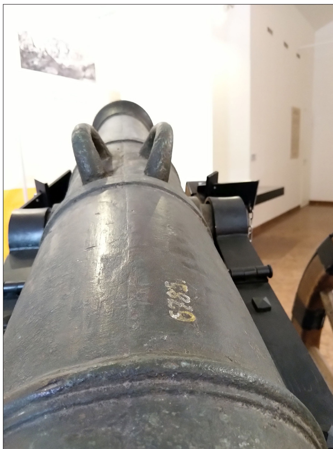
4. ábra Az öntőforma illesztési felületének a nyoma
